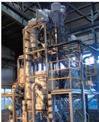
でのプラント設置も行いました。「バイオマスペンタジェンシステム」という名称で、もみ殻などの材料から、炭、電気、酢液、バイオオイル、温水の5つの製品・エネルギーが製造できる装置を開発したところ、新たな公募事業に採択されて、今、工事を進めているところです。
